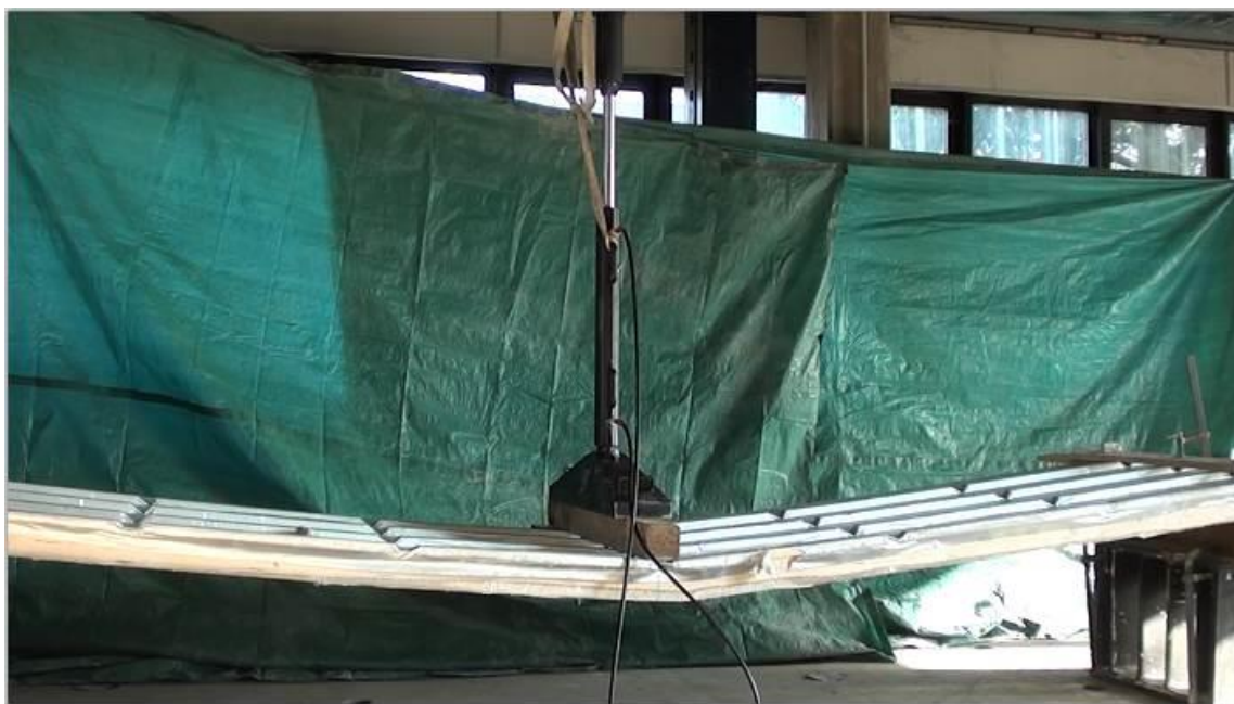
Fase di rottura
